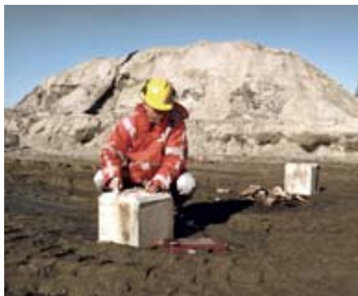
Akoestische meting prefabbetonpaal
